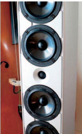
**elektronischen Phaseshifts nach.** Dabei werden die beiden äusseren Bass-Mitteltöner zeitlich etwas verzögert. In der Folge arbeiten die fünf einzelnen Lautsprecherchassis wie eine halbkugelförmige Einheit. Diese strahlt die akustische Energie über den gesamten Frequenzbereich nicht nur gleichmässig, sondern auch phasentreu ab. Das heisst alle Frequenzspektren erreichen den Hörer gleichzeitig und mit richtig dosierter Lautstärke.
