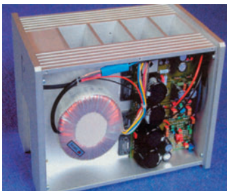
Schönheit und Kraft: Power-Ringkerntransformator und ausgeklügelte Elektronik. Die gleiche Bestückung findet sich auf der anderen Seite.
