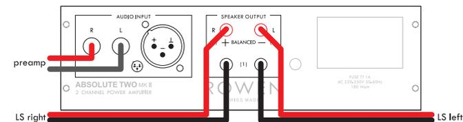
Für den Stereo-Betrieb benötigen Sie ein ROWEN-Absolute-Kabel mit Cinch Stecker für die Verbindung zwischen Vorverstärker und ABSOLUTE TWO Endverstärker.
