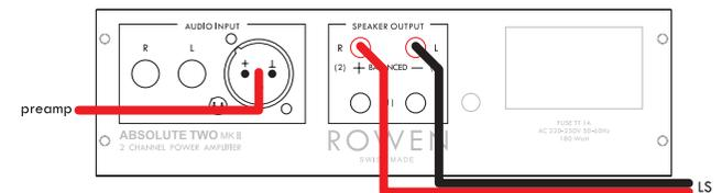
Für den symmetrischen Betrieb mit vierfacher Leistung benötigen Sie pro Kanal ein ROWEN-Absolute XLR-XLR Kabel für die Verbindung zum ABSOLUTE PRE Vorverstärker. Bei Vorverstärkern, die keinen echt symmetrischen Ausgang aufweisen, benötigen Sie ein ROWEN SYM1 Transformer Modul pro Kanal.
