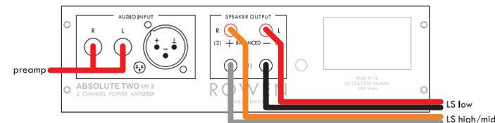
Für den Bi-Amping-Betrieb benötigen Sie pro Kanal ein ROWEN-Absolute-Kabel Cinch auf 2 Cinch für die Verbindung zwischen Vorverstärker und ABSOLUTE TWO Endverstärker.
