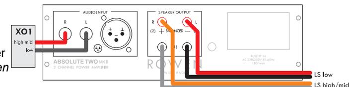
Für den Bi-Active-Betrieb benötigen Sie pro Kanal ein ROWEN XO1 oder XO2 Crossover Modul für die Verbindung zwischen Vorverstärker und ABSOLUTE TWO Endverstärker.
