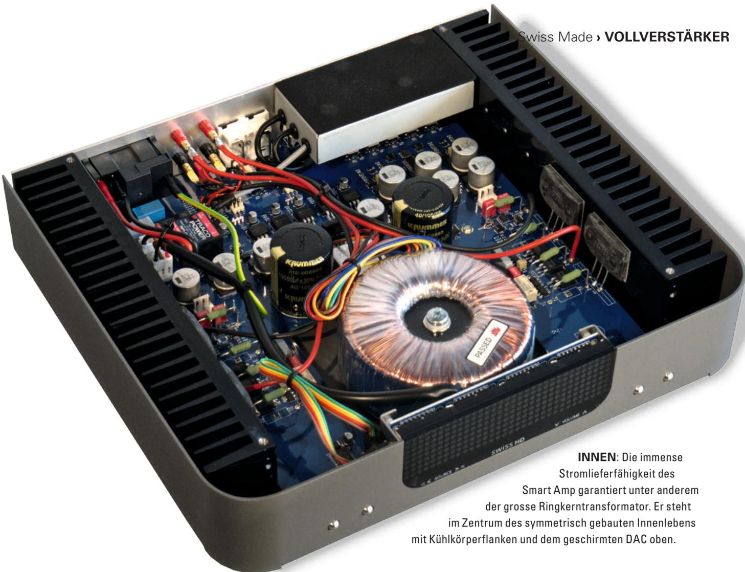
**INNEN:** Die immense Stromlieferfähigkeit des Smart Amp garantiert unter anderem der grosse Ringkerntransformator. Er steht im Zentrum des symmetrisch gebauten Innenlebens mit Kühlkörperflanken und dem geschirmten DAC oben.
